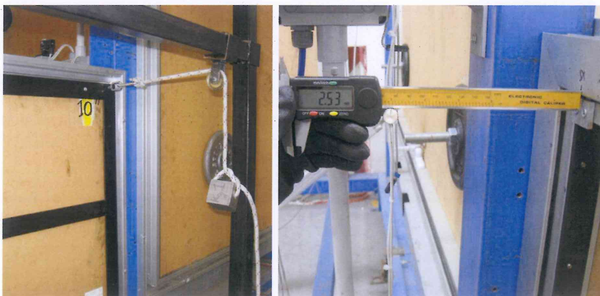
Foto 1 e Foto2. Campione sottoposto a prova durante il test di serraggio a trazione.
