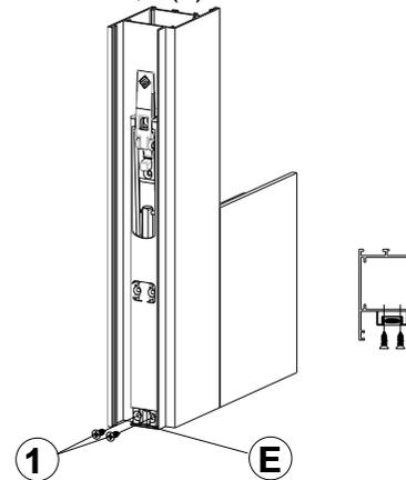
Infilare il resto del corpo del catenaccio sul blocchetto terminale "E" fino a completa battuta; in posizione di apertura, eseguire i fori da 2,5 mm e fissare le viti autof. da 2,9 mm (2).
