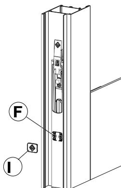
Montaggio catenaccio a leva con incontro a pozzetto.
