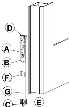
Posizionare il catenaccio, eseguire due fori  $\varnothing$  2,5 mm per il fissaggio del blocchetto "E", quindi serrare con le viti 2,9 (1) in dotazione.
