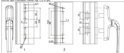
Infilare la macchinetta nel profilo, avvitando le viti nei fori filettati predisposti sulla macchinetta.
