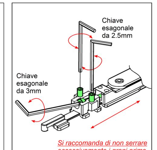
Il kit anta ribalta viene fornito premontato per ante incernierate a destra; per invertire la mano di apertura, modificare la cremone (Dis. 1), il blocchetto di collegamento (Dis. 2) e la cerniera inferiore (Dis. 3).
