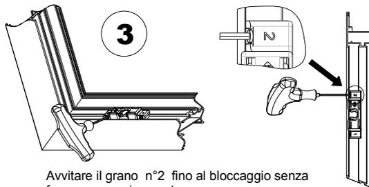
Avvitare il grano n°2 fino al bloccaggio senza forzare eccessivamente.
