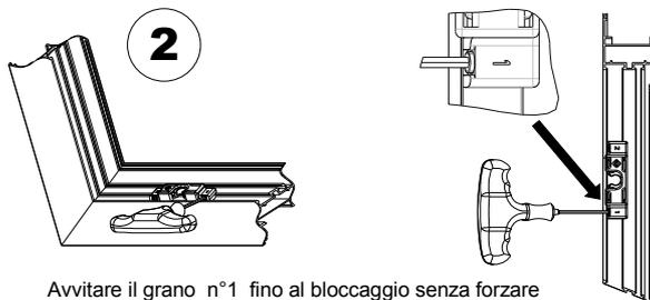
Avvitare il grano n°1 fino al bloccaggio senza forzare eccessivamente.
