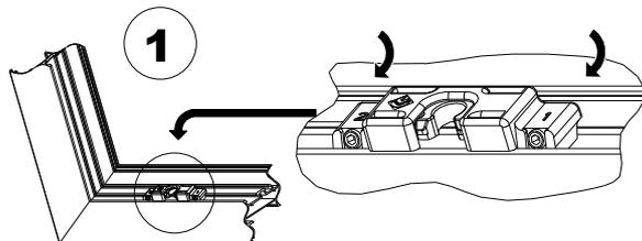
Infilare la clip nel telaio come indicato in figura
