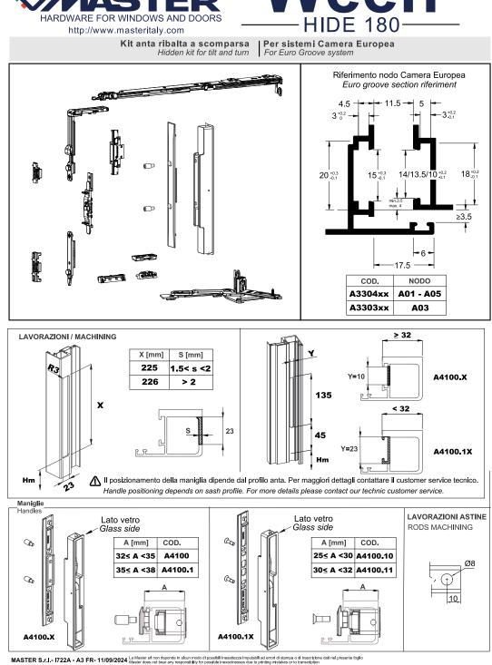
Posizionamento punti chiusura | Positioning locking points | Positionnement points de fermeture | Posicionamiento puntos de cierre
