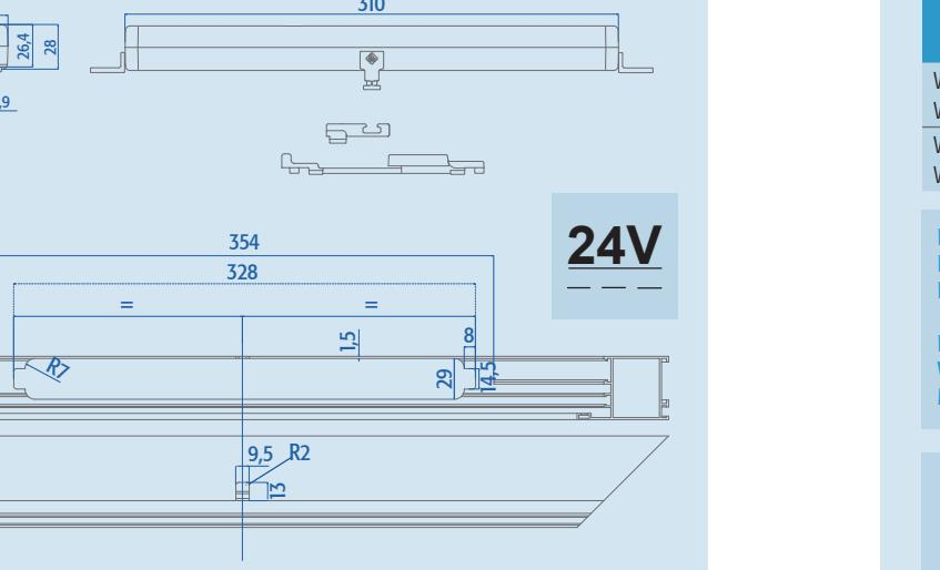
Versione base de l'actionneur invisible avec mécanisme d'accrochage/déroulage breveté et universel. Il est utilisé pour le transom et l'ouverture extérieure, ouverte par bouton.
