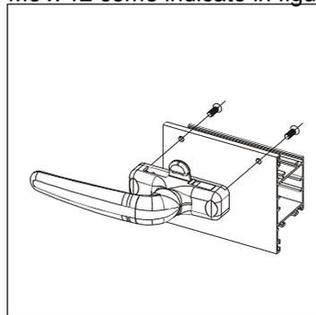
Accoppiare i componenti [6], [7] e se necessario gli spessori [A], fissarli al profilo con viti autofilettanti, infilare il copri riscontro [8]
