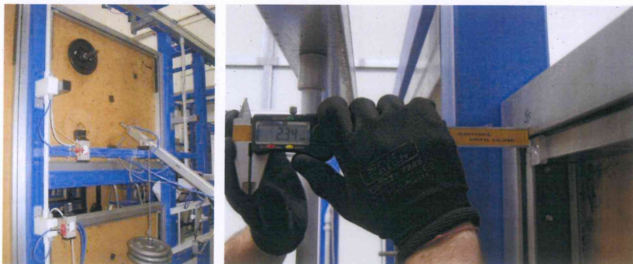
Foto 1 e Foto2. Campione sottoposto a prova durante il test di serraggio a trazione.
