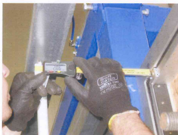
Foto 1 e Foto2. Campione sottoposto a prova durante il test di serraggio a trazione.
