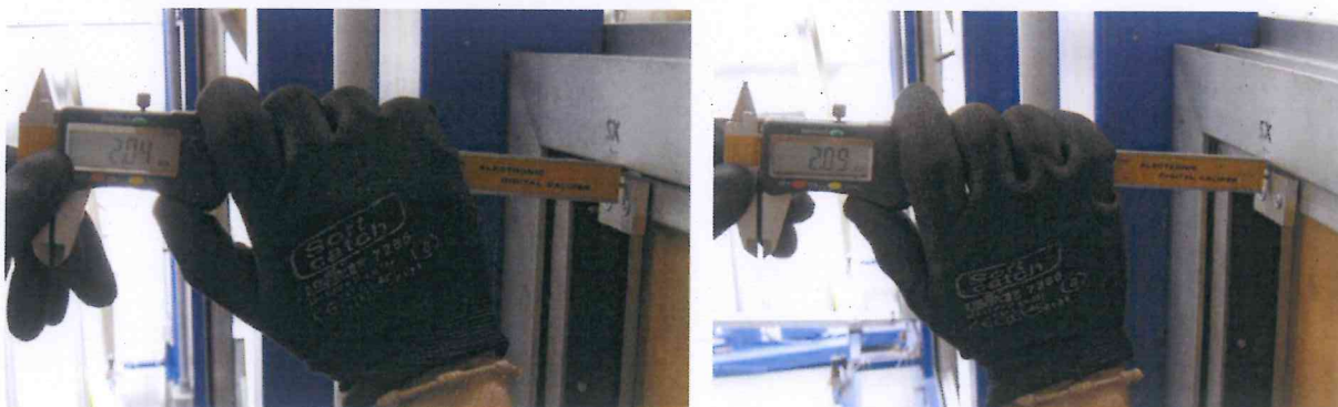
Foto 1 e Foto2. Campione sottoposto a prova durante il test di serraggio a trazione.
