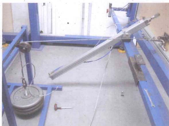
Foto 1 e Foto2. Campione sottoposto a prova durante il test di serraggio a trazione.
