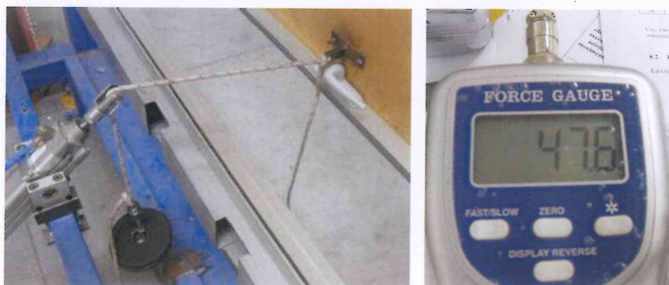
Foto 3 e Foto 4. Campione sottoposto a prova durante il test di frizionamento
