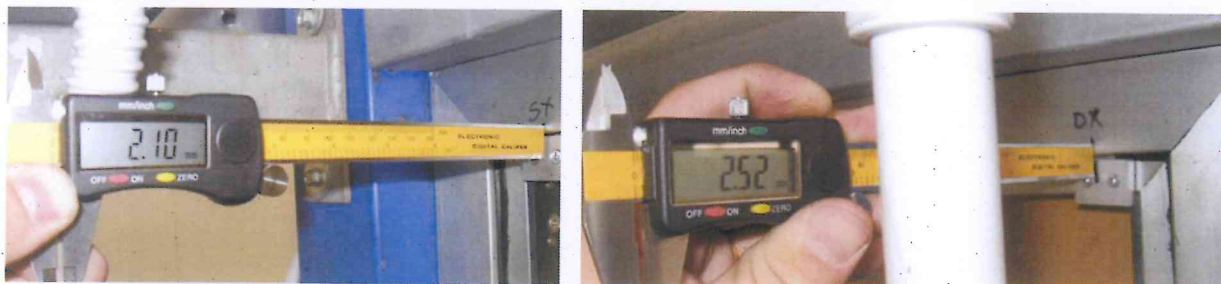
Foto 1 e Foto2. Campione sottoposto a prova durante il test di serraggio a trazione
