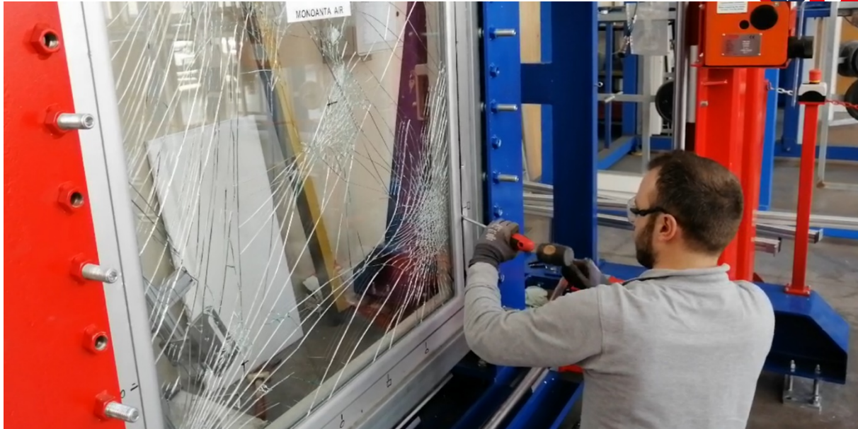
FIGURE 2 IMAGE REPRESENTATIVE D'UN ESSAI D'ATTAQUE MANUEL POUR TEST RC2 OU RC3
