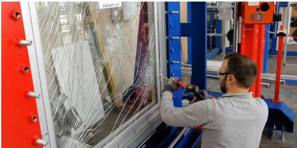
FIGURA 2 IMAGEN QUE REPRESENTA UNA PRUEBA DE ATAQUE MANUAL PARA TEST RC2 O RC3
