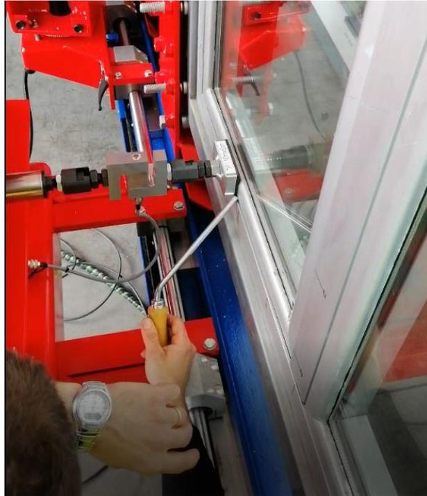
FIGURA 1 IMAGEN QUE REPRESENTA UNA PRUEBA DE ATAQUE ESTÁTICO PARA TEST RC2 O RC3
